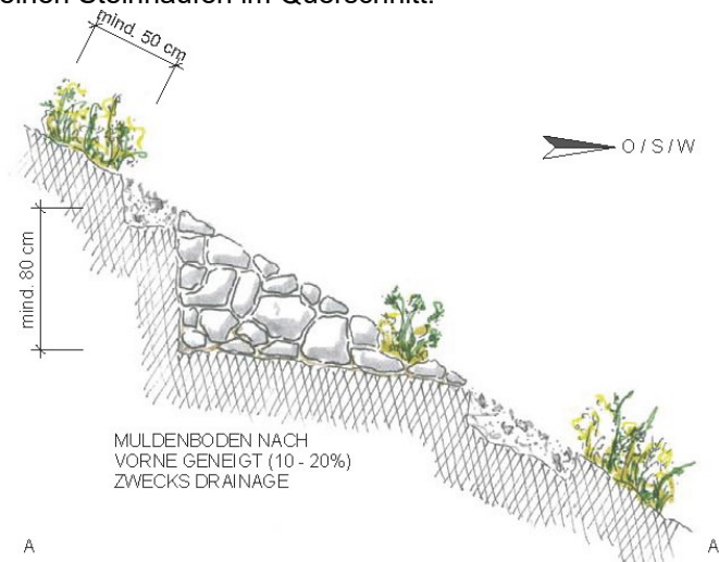
Abb. 8: Steinlinse im Querschnitt (Quelle: Barbara Kirsch / karch)
